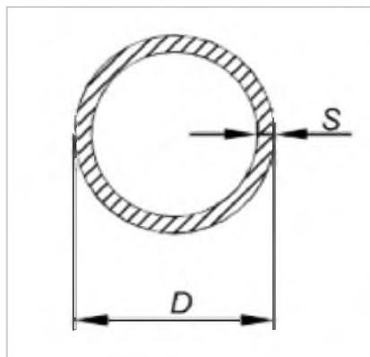
Труба нержавеющая изготовлена из стали AISI 304, AISI 316L
